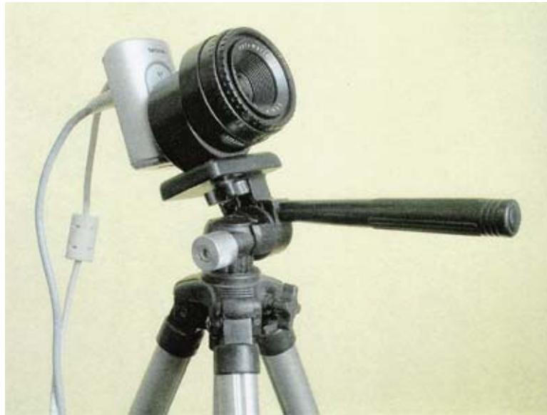
Webcam Philips ToUcam Pro II ligada a uma lente Domiplan 2.8/50, através de um adaptador de nova versão. A pega da montagem está orientada para a frente propositadamente, caso contrário tornaria difícil a observação de objectos localizados muito acima do horizonte ou mesmo no zénite.
