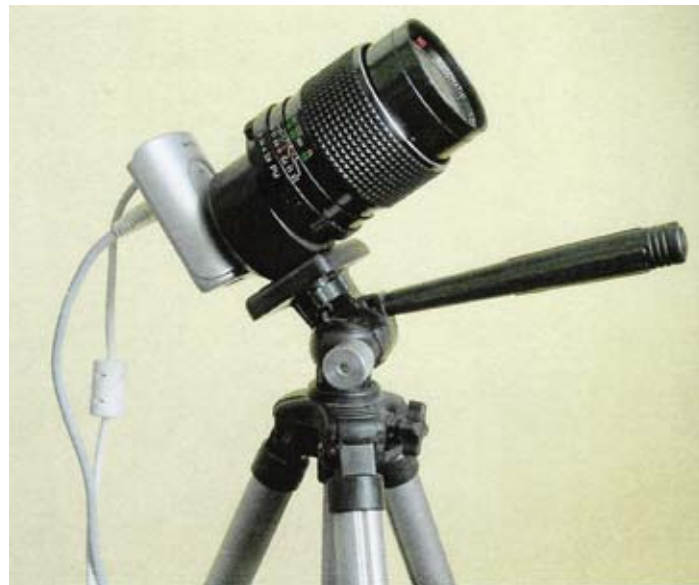
Webcam Philips ToUcam Pro II com uma lente Helios zoom de 2.8/135
